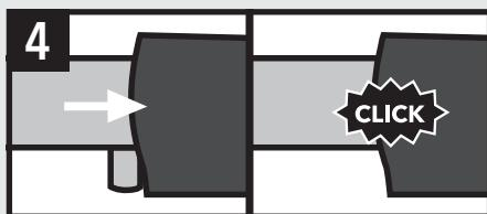
**4.** Faites glisser la barre de support métallique à travers le tissu de la table à langer. Réattacher les panneaux latéraux en plastique à chaque extrémité de la barre de support métallique en alignant le bouton de dégagement de chaque extrémité de la barre de support métallique sur les trous des panneaux latéraux en plastique et pousser en place jusqu'à ce que vous entendiez un «clic».
