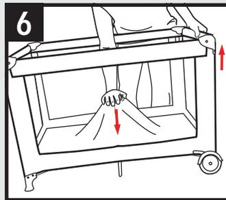
6. Soulever légèrement une extrémité du parc et pousser le mécanisme de verrouillage vers le bas.
